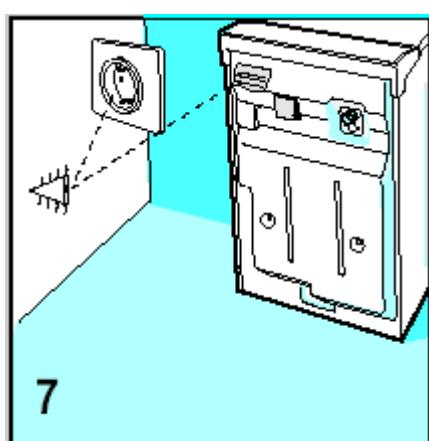
Проверить, чтобы напряжение, указанное на маркировочной табличке, расположенной на задней стороне стиральной машины, соответствовало напряжению электрической сети.
