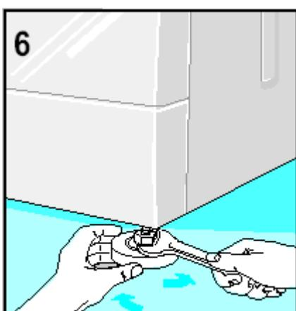
Чтобы машина работала хорошо, необходимо выставить ее по уровню. Для этого отрегулировать должным образом ножки в основании прибора (Рис. 6) (2 ножки на машинах с задними колесиками, 4 – в машинах без колесиков). Выставив машину по уровню, закрепить регулировочные ножки, прикрутив гайки к основанию машины гаечным ключом.
