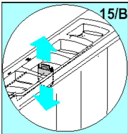
**Прим.** Не забудьте поднять перегородку, когда в машину засыпается стиральный порошок.
