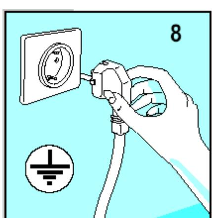
Электрическая розетка, к которой подключается стиральная машина, должна быть оснащена системой заземления; в противном случае изготовитель не несет ответственности за несчастные случаи (Рис. 8).
